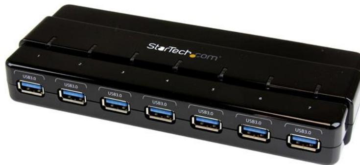
El concentrador USB 3.0, modelo ST7300USB3B, permite agregar siete puertos USB 3.0 a un ordenador, mediante una única conexión anfitrión USB 3.0.
