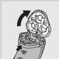
**2** Stiskněte uvolňovací tlačítko a otevřete holicí jednotku.
