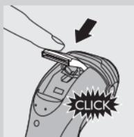
**3** Zastříhovač otevřete stisknutím posuvného tlačítka směrem dolů.
