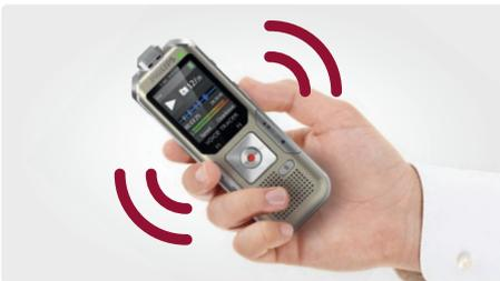
Le capteur de mouvement intégré détecte quand l'enregistreur est placé sur un bureau ou tenu en main, et sélectionne la sensibilité du microphone en fonction de la situation d'enregistrement. Cela vous évite d'étouffer accidentellement le son que vous souhaitez enregistrer.
