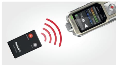
La télécommande fournie permet un placement pratique de l'enregistreur pour répondre parfaitement aux besoins de l'environnement audio tout en conservant la facilité d'utilisation. Démarrer, suspendre et arrêter l'enregistrement sans faire de contorsions quand l'appareil est à distance.
