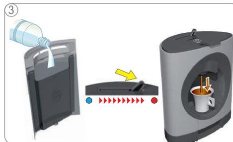
③ Controllare se c'è dell'acqua nel serbatoio: in caso negativo, riempire e spostare nuovamente la leva nella posizione freddo/caldo per proseguire la preparazione; se il serbatoio è pieno, procedere come segue:
