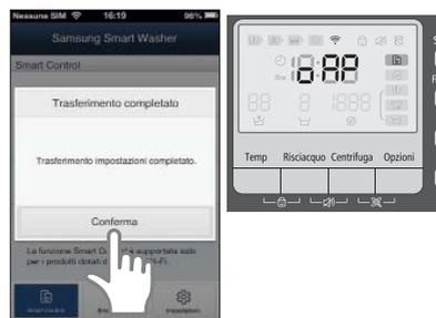
16. Dopo aver collegato lo smartphone alla macchina, premere i tasti **Temp + Avvio/Pausa** contemporaneamente per 5 secondi. Dopo 5 secondi, sul pannello a LED verrà visualizzato il programma di lavaggio.
