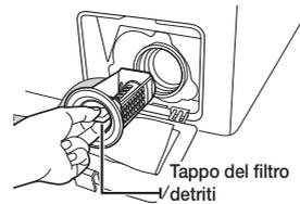
5. Pulire accuratamente il filtro detriti rimuovendo ogni residuo. Assicurarsi che l'elica della pompa di scarico dietro il filtro detriti non sia bloccata.
