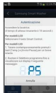
6. Una volta visualizzato "AP" ruotare la manopola in senso orario fino alla comparsa del codice "PS". Dopo aver visualizzato "PS" premere il tasto **Avvio/Pausa**.
