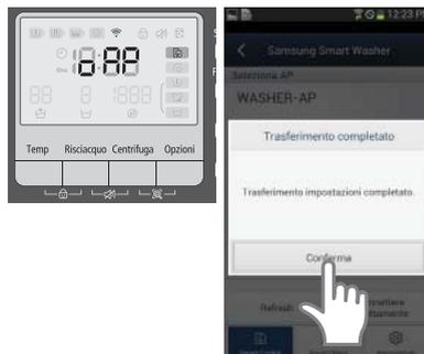
19. Dopo aver collegato lo smartphone alla macchina, premere i tasti **Temp + Avvio/Pausa** contemporaneamente per 5 secondi. Sul pannello a LED verrà visualizzato il programma di lavaggio.
