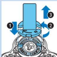
**2** 將固定環座放置於固定環上 (1)，向逆時鐘方向旋轉 (2)，然後將其自電鬚刀刀頭拿起 (3)。
