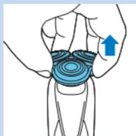
**3** 將電鬚刀刀頭固定座從電鬚刀組底部抽出。
