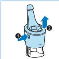
**1** 按 SmartClean 系统侧面上的按钮 (1)，然后提起 SmartClean 系统的顶部 (2)。
