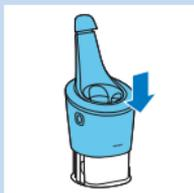
**6** 将 SmartClean 系统的顶部向下推回去（可听到“咔哒”一声）。
