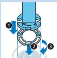
**7** 将固定环支架放置在固定环上 (1)，将其放在剃须刀头上 (2)，然后顺时针旋转 (3) 以重新安装固定环。
