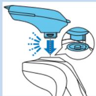
**3** 将胡须造型器附件的凸缘插入产品顶部的槽内。然后按下胡须造型器附件以将其安装在产品上（可听到“咔哒”一声）。
