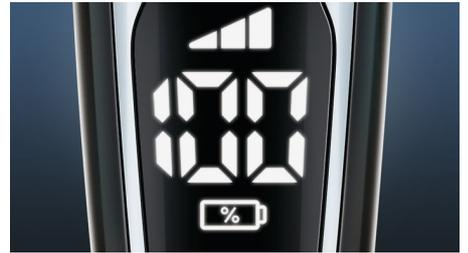
Das intuitive Display zeigt relevante Informationen an, sodass Sie die beste Leistung Ihres Rasierers erhalten: – Akkustandsanzeige mit 3 Ziffern (%) – Reinigungsanzeige – Anzeige für niedrigen Akkustand – Erinnerung zum Scherkopfaustausch – Reisesicherungsanzeige
