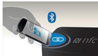
Empareja dispositivos Bluetooth fácilmente con la tecnología de un toque NFC (comunicaciones por proximidad). Solo tienes que tocar con el smartphone o la tableta con NFC la zona NFC del altavoz para encenderlo, iniciar el emparejamiento a través de Bluetooth y comenzar a transmitir música.
