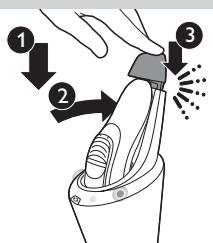
**3** Placera rakapparaten i hållaren (1), luta rakapparaten bakåt (2) och tryck ned det övre locket för att ansluta rakapparaten (ett klickljud hörs) (3).
