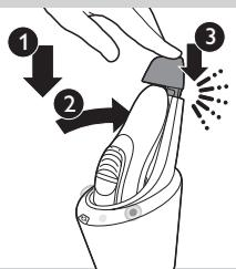
**3** Coloque la afeitadora en el soporte (1), incline la afeitadora hacia atrás (2) y presione hacia abajo la parte superior para conectar la afeitadora (“clic”) (3).
