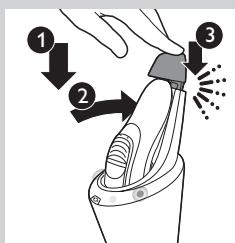
**3** Coloque a máquina de barbear no suporte (1), incline a máquina para trás (2) e pressione a tampa superior para conectar a máquina de barbear (ouve-se um estalido) (3).
