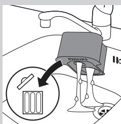
**2** Entfernen Sie die leere Reinigungskartusche aus dem SmartClean-System, und gießen Sie verbleibende Rückstände von Reinigungslösung aus der Reinigungskartusche.
