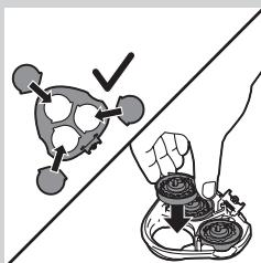
Hinweis: Die Vorsprünge an den Scherköpfen müssen genau in die Aussparungen der Schereinheit passen.
