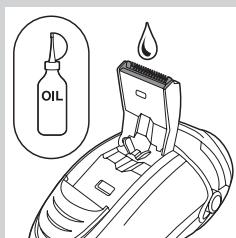
İpucu: Optimum düzeltme performansı için düzelticinin dışlarını altı ayda bir, bir damla dikiş makinesi yağıyla yağlayın.
