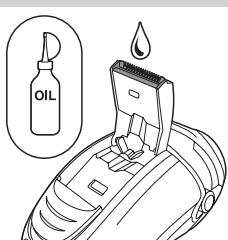
Tip: Smør trimmerens tænder med en dråbe symaskineolie hver 6. måned for at bevare optimal trimmerfunktion.
