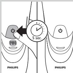
**9** Tryk på on/off-knappen, og hold den inde i 5 sekunder for at nulstille udskiftningspåmindelsen på shaveren. Den orange indikator slukker.
