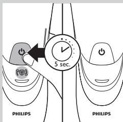
**9** Trykk på og hold av/på-knappen nede i fem sekunder for å tilbakestille påminnelsen om å skifte ut på barbermaskinen. Den oransje lampen slukkes.
