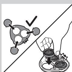
**8** Volte a colocar as cabeças de corte no acessório de corte.
