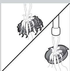
**7** Ta bort kniven från rakningsskyddet och rengör den under rinnande vatten. Rengör sedan insidan och utsidan av rakningsskyddet under kranen.
