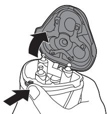
**5** Ruotate il sistema di bloccaggio in senso antiorario (A) e rimuovete la struttura di supporto (B).
