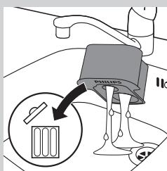
**2** Haal de lege reinigingscartridge uit het SmartClean-systeem en giet eventuele resterende reinigingsvloeistof uit de reinigingscartridge. U kunt de reinigingsvloeistof gewoon door de gootsteen gieten.
