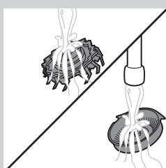
**7** Retire a lâmina da protecção de corte e lave-a em água corrente. Em seguida, lave o interior e o exterior da protecção de corte em água corrente.
