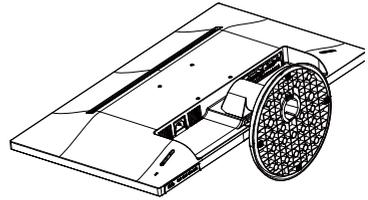
2. Bringen Sie die Basisssäule so am Monitor an, dass sie einrastet.
