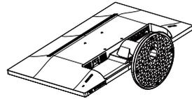
2. Drücken Sie zum Entfernen der Basis von der Basissäule die Freigabeclips zusammen.
