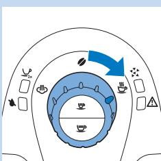
**5** Ruotate il selettori sull'icona dell'acqua calda.
