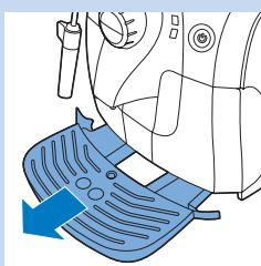
**7** Entfernen Sie die Auffangschale, spülen Sie sie aus, und setzen Sie sie wieder ein.
