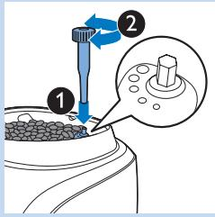
Non ruotate la manopola di regolazione del grado di macinatura più di un livello alla volta per evitare di danneggiare il macinacaffè.
