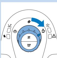
**5** Drehen Sie den Drehschalter auf das Heißwassersymbol.
