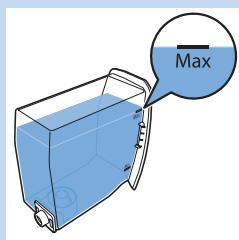
3 Riempite il serbatoio con acqua fredda del rubinetto fino al livello massimo (MAX).
