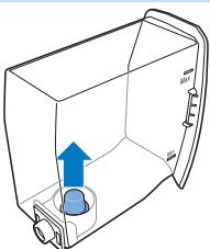
Vi consigliamo di installare il filtro dell'acqua Intenza+ per prevenire la formazione di calcare all'interno della macchina. Potete acquistare il filtro dell'acqua Intenza+ separatamente. Per ulteriori dettagli, vedere il capitolo "Garanzia e assistenza", sezione "Ordinazione dei prodotti per la manutenzione".
