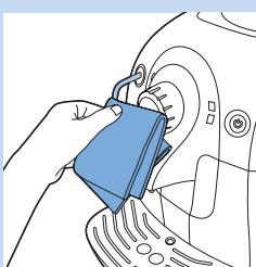
**3** Pulire l'erogatore di acqua calda/vapore con un panno bagnato per rimuovere eventuali residui di latte.
