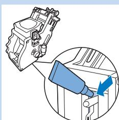
Per ottimizzare le prestazioni della macchina, lubrificate il gruppo infusore dopo aver preparato 500 tazze di caffè o una volta ogni 3 mesi. Contattate il numero Philips Saeco per acquistare il lubrificante.
