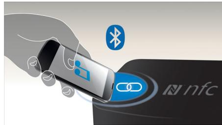
Koppeln Sie Bluetooth-Geräte mit der One-Touch-NFC-Technologie (Near Field Communications) durch eine einfache Berührung. Berühren Sie das NFC-fähige Smartphone oder Tablet im NFC-Bereich eines Lautsprechers, um den Lautsprecher einzuschalten, die Bluetooth-Kopplung zu starten und mit der Musikübertragung zu beginnen.
