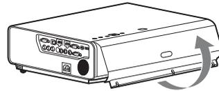
Puede quitar la cubierta de la lámpara durante la instalación en el techo. Tenga cuidado para que la lámpara no se caiga, ya que no está fijada. No aplique presión a la cubierta de la lámpara cuando esté abierta.
