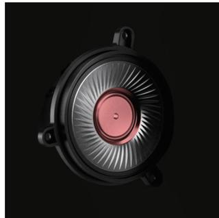
Les haut-parleurs à contrôle de mouvement multicouche (LMC) sont dotés d'un diaphragme en polymère multicouche encapsulant une couche de gel amortissant.
