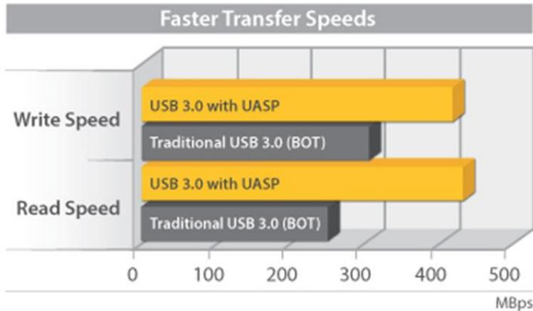
Durante i test con lo stesso picco, UASP presenta inoltre una riduzione dell'80% delle risorse del processore necessarie.
