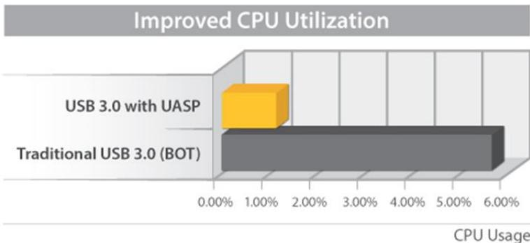
I risultati dei test sono stati ottenuti utilizzando un sistema Ivy Bridge Intel®, un box esterno StarTech.com dotato di UASP e un'unità a stato solido SATA III.
