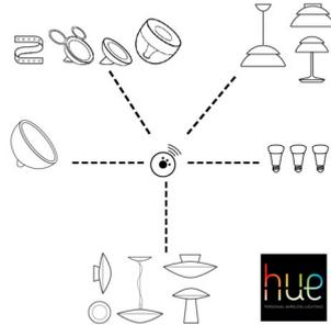
Vous pouvez connecter jusqu'à 50 ampoules ou lampes au pont Philips hue. Commencez par n'importe lequel des kits de démarrage, et complétez-le par des produits Philips hue. Vous pourrez ensuite contrôler votre éclairage du bout du doigt au moyen de l'application intuitive Philips hue pour smartphones iOS et Android.
