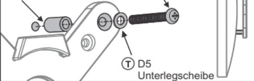
7 Hängen Sie den Monitor an den Arm und befestigen Sie diesen mit dem 3 mm Sechskantschlüssel
