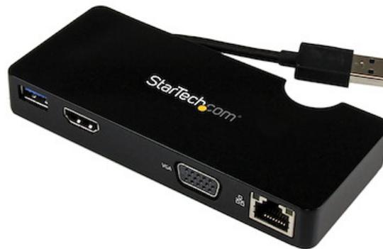
La station d'accueil de voyage pour ordinateur portable transforme votre Ultrabook™ ou votre ordinateur portable en poste de travail mobile en ajoutant une sortie vidéo HDMI® ou VGA, un port hub USB 3.0 et un port Gigabit Ethernet RJ45 au moyen d'une seule connexion hôte USB 3.0. Conviviale, elle compense le manque de ports d'appareils portables d'aujourd'hui, ce qui est parfait pour votre ordinateur portable, Microsoft Surface™ Pro 4, Surface Pro 3, Surface 3, Surface Pro 2 ou Surface Book.
