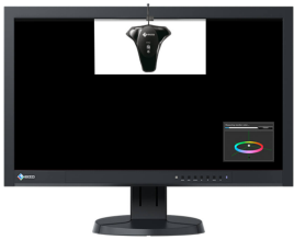
Bepaling van witpunt- en helderheidswaarden bij de kalibratie met behulp van een externe sensor
