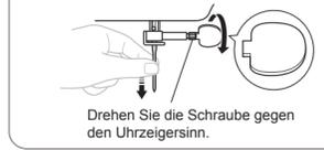
Drehen Sie die Schraube gegen den Uhrzeigersinn.
