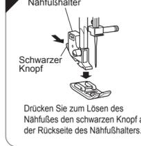
Drücken Sie zum Lösen des Nähfußes den schwarzen Knopf an der Rückseite des Nähfußhalters.
