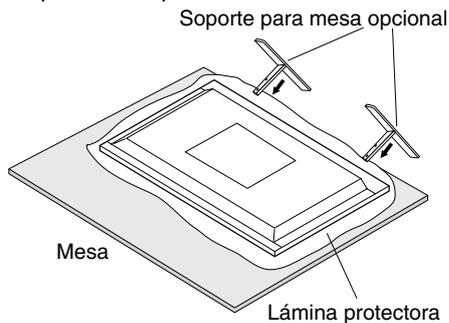
**NOTA:** Instale el soporte según la dirección que indica la flecha que está impresa en la superficie del soporte. Use el ST-801.
