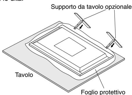
**NOTA:** Montare il supporto nella direzione della freccia che è stampata sulla superficie del supporto. Utilizzare ST-801.
