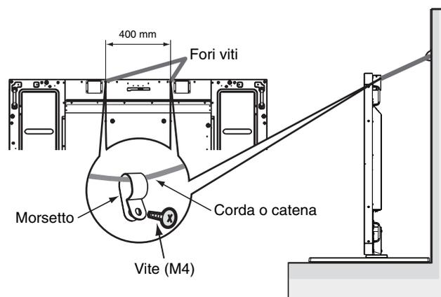
Prima di fissare il monitor LCD alla parete, accertarsi che la parete sia in grado di sostenere il peso del monitor.
