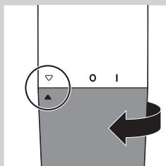
**1** 要卸下电池仓盖，请将其顺时针旋转，直至设置指示符号指向“开”指示。
