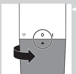
**5** 逆时针旋转电池盒盖，直至设置指示符号指向“关”指示 (0)。
