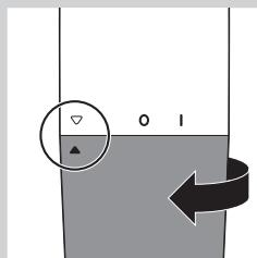
**1** 若要取下電池槽蓋，請以順時針方向旋轉，直到設定指示指向「開啟」標示為止。
