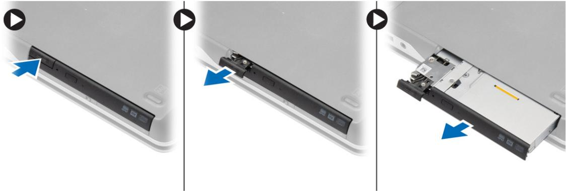
4. Retirez la vis qui fixe le loquet du lecteur de disque optique au lecteur de disque optique. Faites glisser le loquet du lecteur de disque optique, puis retirez-le du lecteur de disque optique.
