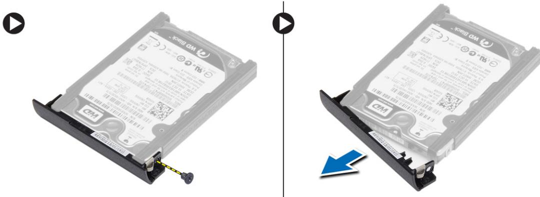
5. Pliez l'isolation de disque dur. Retirez l'isolation du disque dur.
