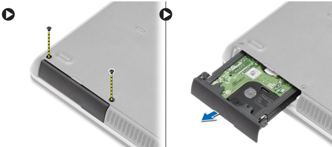
4. Retirez la vis qui fixe le support de disque dur au disque dur. Retirez le support de disque dur de ce dernier.
