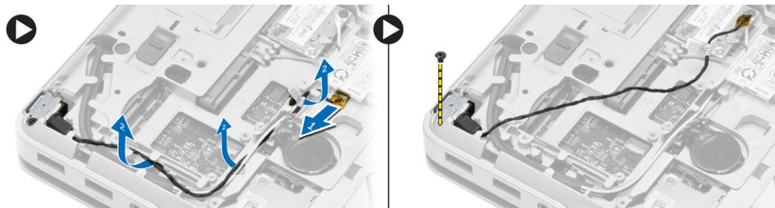
4. Soulevez le support du connecteur réseau pour le retirer de l'ordinateur. Soulevez le connecteur réseau pour le retirer de l'ordinateur.
