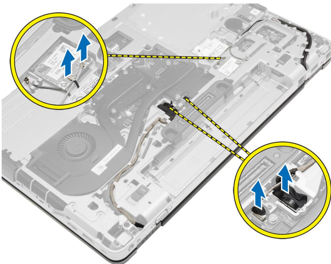
4. Déconnectez le câble LVDS et dégager le câble LVDS et le câble de la caméra des guides d'acheminement. Retirez-les de l'ordinateur.
