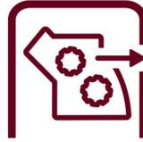
O bloco de preparação é o coração de todas as máquinas de café super automáticas e deve ser limpo regularmente. O bloco de preparação totalmente amovível permite-lhe limpá-lo em profundidade através de um simples enxaguamento em água corrente
