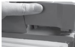
23. Inserire il coprifilo sopra la porta frigo quindi premerlo per completarne l'assemblaggio. Controllare la posizione del cavo che deve essere posizionato sul retro del coprifilo.
