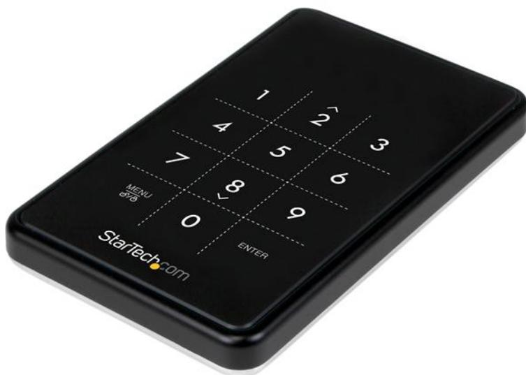
La caja USB 3.0 para disco duro con cifrado, modelo S2510BU33PW, le permite convertir su unidad SATA de disco duro (HDD) o de estado sólido (SSD) de 2,5" en unidad externa con cifrado AES.
