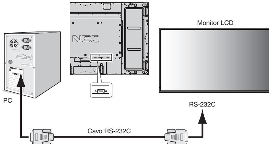
**NOTA:** Se il PC è equipaggiato solo con un connettore a porta seriale a 25 pin, è necessario un adattatore a porta seriale a 25 pin. Contattare il fornitore per i dettagli.
