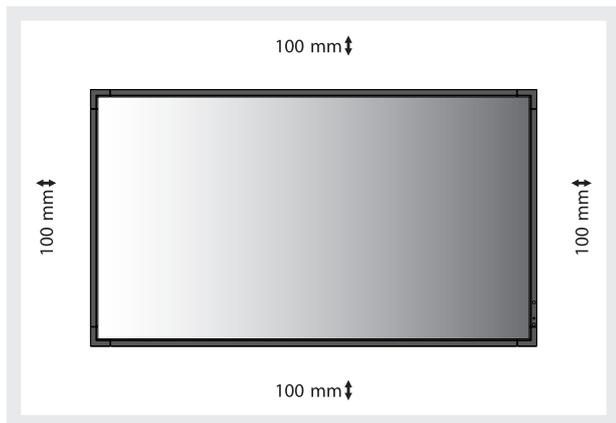
Prevedere un'adeguata ventilazione o il condizionamento dell'aria intorno al monitor in modo tale da dissipare il calore dall'unità e dalla struttura di montaggio, soprattutto quando si usano più monitor affiancati.
