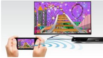
O Miracast™ é uma norma de screencast peer-to-peer sem fios executada através de ligação Wi-Fi Direct. A interface de utilizador simplificada projecta
