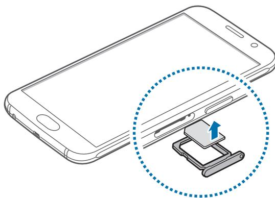
4 Inserite nuovamente il supporto per la scheda SIM nel suo slot.
