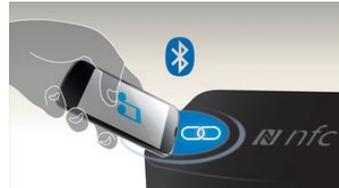
Apparez aisément des appareils Bluetooth® grâce à la technologie NFC (Near Field Communications). Il vous suffit d'approcher le smartphone ou la tablette compatible NFC de la zone NFC d'une enceinte pour allumer celle-ci, activer l'appairage Bluetooth® et commencer à diffuser de la musique.
