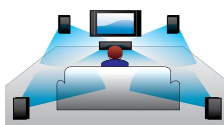
Um decodificador Dolby Digital integrado elimina a necessidade de um decodificador externo ao processar todos os seis canais de informação áudio para proporcionar uma experiência de som surround e uma sensação espantosamente natural de realismo envolvente e dinâmico. O Dolby Pro Logic II proporciona cinco canais de processamento surround a partir de qualquer fonte estéreo.
