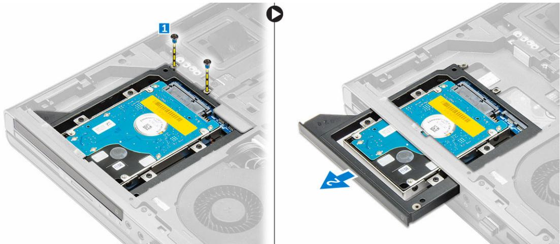
4. Retirez les vis qui fixent le disque dur au bâti du disque dur. Faites glisser et retirez le disque dur du bâti du disque dur.
