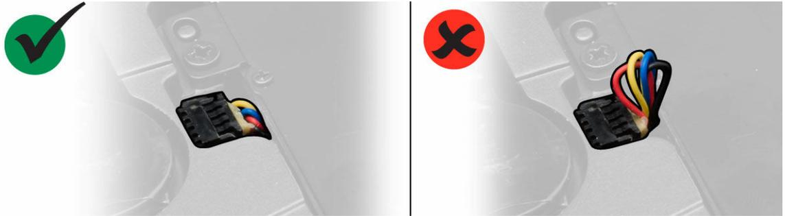
2. Insérez le ventilateur de la carte vidéo dans son emplacement et serrez les vis pour le fixer à l'ordinateur.
