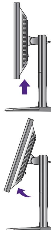
4. Drehen Sie den Monitor um 90 Grad im Uhrzeigersinn, wie in der Abbildung gezeigt wird.
