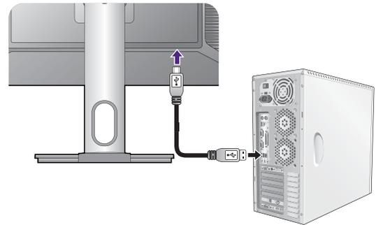
Schließen Sie USB-Geräte über andere USB-Anschlüsse (Downstream) an den Monitor an. Diese Downstream-USB-Anschlüsse übertragen Daten zwischen angeschlossenen USB-Geräten und dem Upstream-Anschluss.
