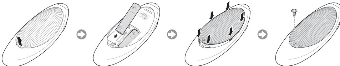
Retirez délicatement le cran du capot du compartiment des piles, puis ôtez complètement le capot lorsqu'il se décolle. Insérez 2 piles alcalines AA en veillant à aligner correctement les polarités positives et négatives.
