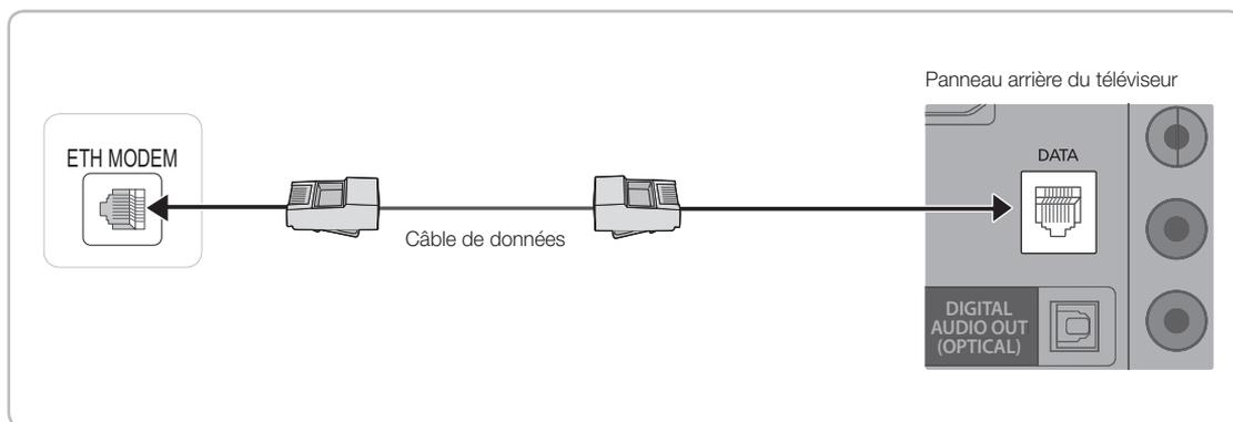
1. Connectez la prise DATA du téléviseur à la prise [ETH MODEM] du STB (SBB) à l'aide d'un câble de données.
