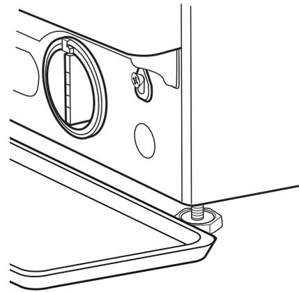
**2.** Recipiente per l'acqua di scarico: Se la lavatrice è dotata di un tubo di scarico di emergenza: Predisporre un recipiente piatto per l'acqua di scarico. Staccare il tubo di scarico di emergenza dalla base della lavatrice.
