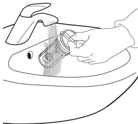
**6.** Inserire il filtro dell'acqua e reinstallare lo zoccolo: Reinserire il filtro dell'acqua ruotandolo in senso orario. Continuare a ruotare fin dove possibile; l'impugnatura del filtro deve trovarsi in posizione verticale. Per provare la tenuta del filtro, versare circa 1 litro d'acqua nella vaschetta del detersivo. Reinstallare lo zoccolo.
