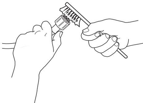
**3.** A questo punto, svitare manualmente il tubo di carico sul lato posteriore della lavatrice. Usando una pinza, estrarre il filtro a rete dalla valvola sul retro della lavatrice e pulirlo.
