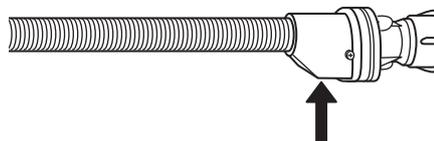
Per i tubi anti-allagamento: controllare la finestrella di ispezione della valvola di sicurezza (vedere la freccia). Se è rossa, significa che la funzione anti-allagamento si è attivata; in questo caso il tubo deve essere sostituito con uno nuovo.
