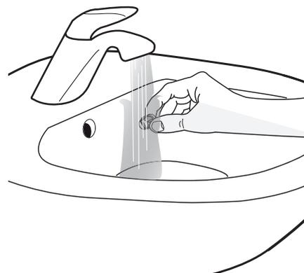
**4.** Reinscrivere il filtro a rete. Ricollegare il tubo di carico al rubinetto dell'acqua e alla lavatrice. Non usare utensili per collegare il tubo di carico. Aprire il rubinetto dell'acqua e controllare che tutti i collegamenti siano ben stretti.
