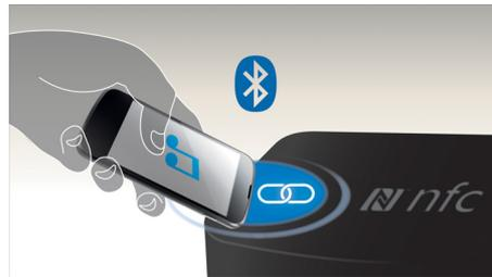
Koppeln Sie Bluetooth-Geräte mit der One-Touch-NFC-Technologie (Near Field Communications) durch eine einfache Berührung. Berühren Sie das NFC-fähige Smartphone oder Tablet im NFC-Bereich eines Lautsprechers, um den Lautsprecher
