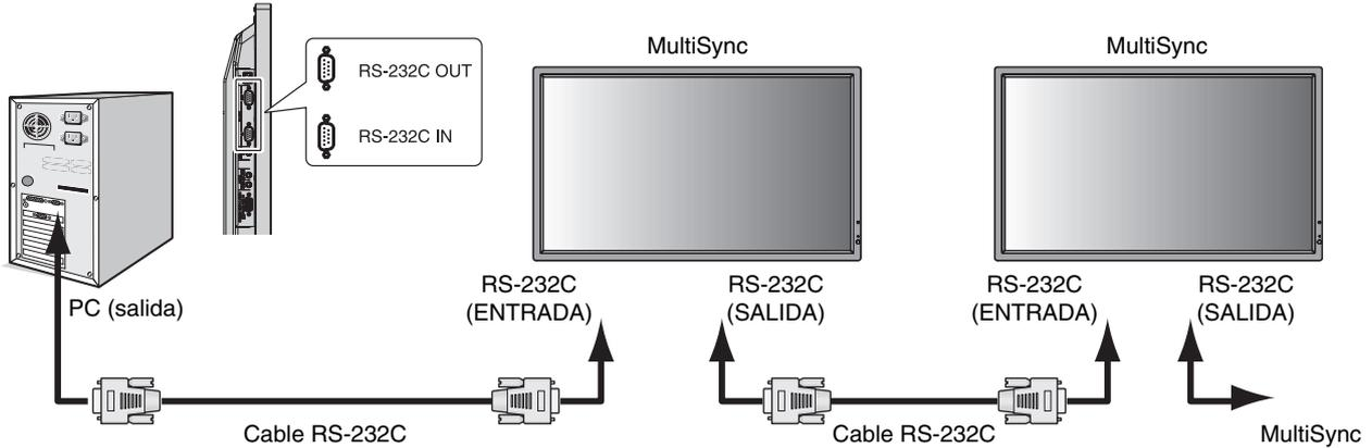
**NOTA:** si el PC sólo tiene un conector de puerto serie de 25 clavijas, es necesario un adaptador de puerto serie de 25 clavijas. Póngase en contacto con su distribuidor si desea más información. Compruebe la opción "ID= TODOS RESPONDEN" en "CONTROL EXTERNO".
