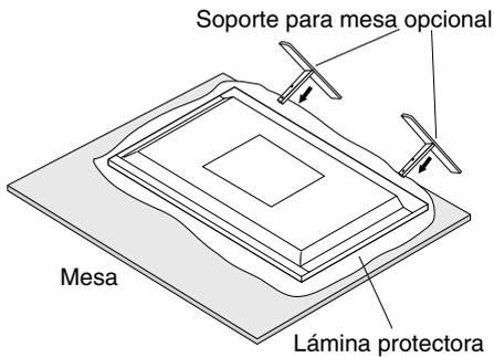
**NOTA:** Instale el soporte según la dirección que indica la flecha que está impresa en la superficie del soporte. Use el ST-322 para V323-2.
