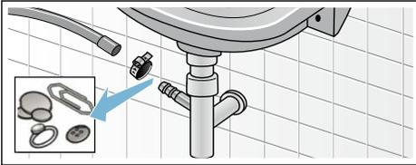
4. Ablaufschlauch wieder anschließen und Verbindungsstelle mit Schlauchschelle befestigen.
