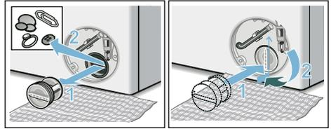
6. Service-Klappe einsetzen, einrasten und schließen.
