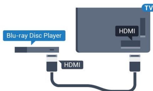
Wenn der Blu-ray Disc-Player über EasyLink HDMI-CEC verfügt, können Sie den Player mit der Fernbedienung des Fernsehers steuern.
