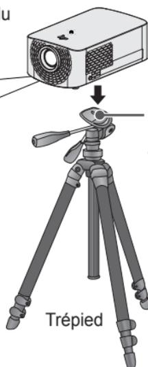
Boulon utilisé pour fixer le projecteur au trépied
