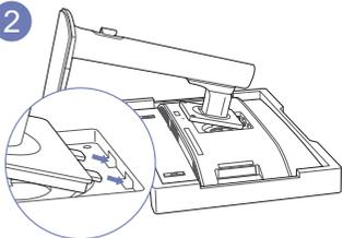
Insérez les languettes du support dans les fentes situées à l'arrière du produit dans le sens des flèches.
