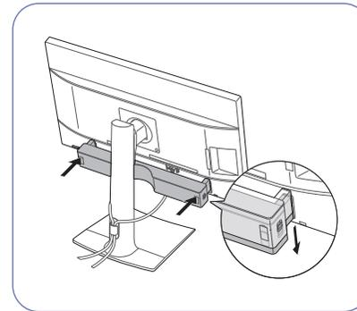
Insérez les barres de connecteurs de la barre de son dans les fentes sur les côtés, puis appuyez dans le sens de la flèche pour fixer la barre de son.
