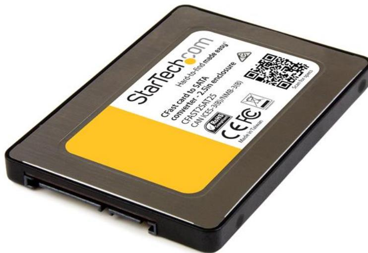
Ahora puede utilizar su tarjeta de memoria CFast™ como una unidad de disco SSD SATA de 2.5". Este singular adaptador le permite el acceso y la recuperación de datos desde una tarjeta CFast, a través de SATA, a velocidades más rápidas de transferencia de datos.
