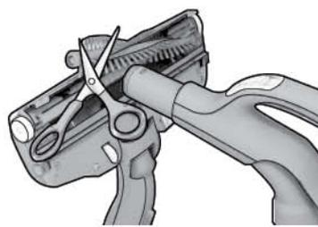
2. Tõmmake harjarull välja ning eemaldage mässitud lõimed lõigates neid kääridega ära. Kasutage harja puhastamiseks vooliku käepidet. Pange detailid kokku vastupidises järjestuses.
