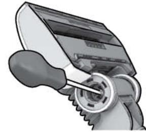
3. Keerake lahti ratta telg ning puhastage kõik osad. Pange detailid kokku vastupidises järjestuses.
