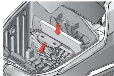
**8. Vahetage mootorifilter, kui see on must või iga viienda s-bagi\* vahetuse järel.** Lükake filtrihooldja alla ja tõmmake see välja. Vahetage filter ja sulgege kaas.
