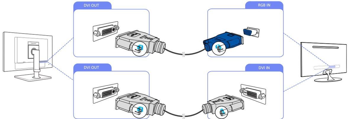
1 Connectez le port [DVI OUT] sur le produit au port [DVI IN] ou [RGB IN] d'un autre moniteur à l'aide d'un câble DVI ou d'un câble DIV-D-SUB.
