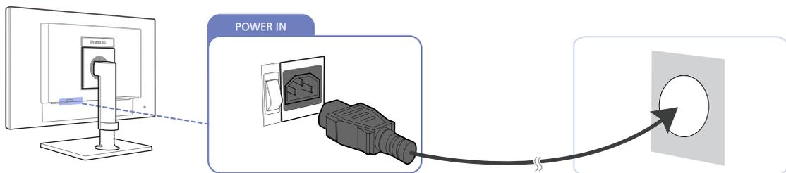
1 Connectez le câble d'alimentation au produit et à la prise de courant, puis appuyez sur l'interrupteur d'alimentation pour mettre sous tension.
