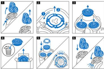
1. Abra o barbeador pressionando o botão de liberação; 2. Remova os anéis de retenção girando-os no sentido anti-horário; 3. Retire as
