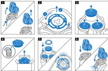
1. Ouvrez le rasoir en appuyant sur le bouton de déverrouillage. 2. Retirez les bagues de fixation en les tournant dans le sens inverse des aiguilles
