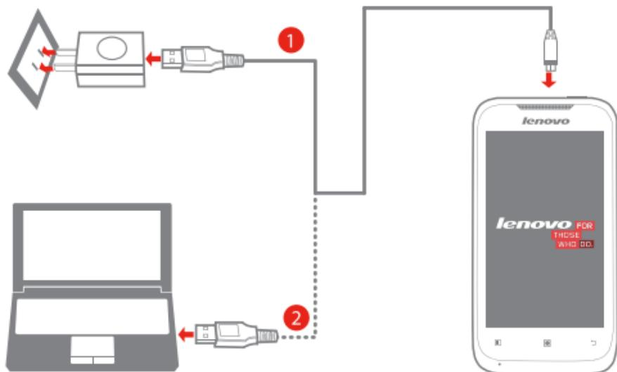
**Способ 1.** Подключите телефон к электрической розетке, используя адаптер электропитания и кабель USB, входящие в комплект поставки, или
