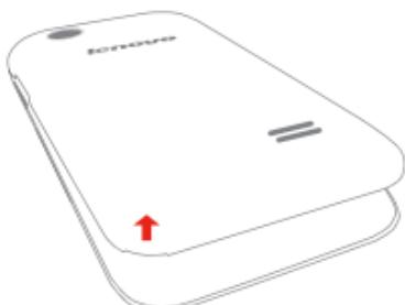
**Шаг 1.** Снимите заднюю крышку.
