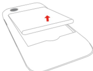
**Шаг 2.** Поднимите аккумулятор из небольшого отсека для батареи.
